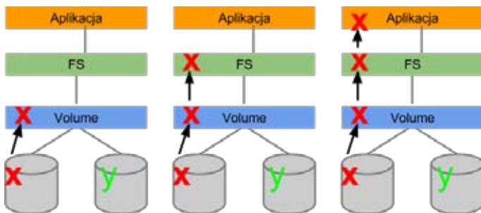
Rysunek 3. Odczyt danych z macierzy RAID 1 przy oddzielnym systemie plików i menadżerze woluminów
